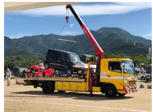
道路啓開訓練（放置車両レッカー移動）
