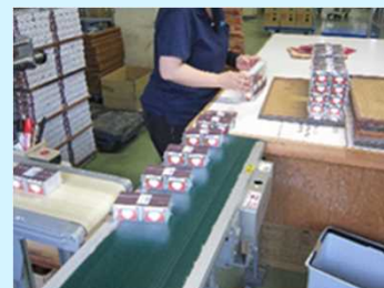
箱詰めされたマッチを人の目でしっかりとチェック
