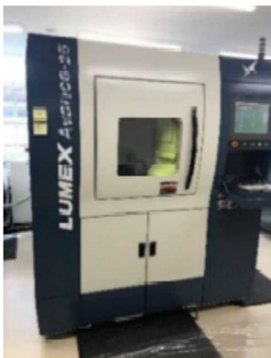
【金属新素材研究センター：レーザービーム式金属用3Dプリンタ】
