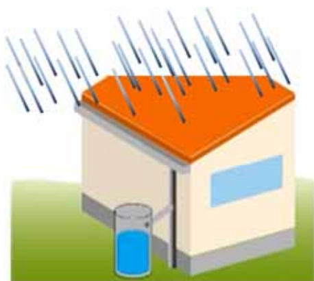
屋根に降った雨水を貯留
