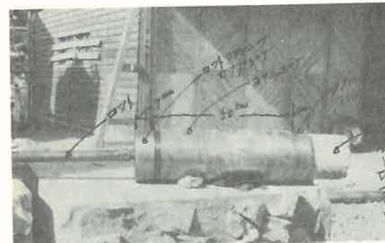
粗石コンクリート、テストピース採取
